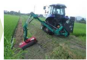
機械による草刈作業 (幅広畦畔を利用)
