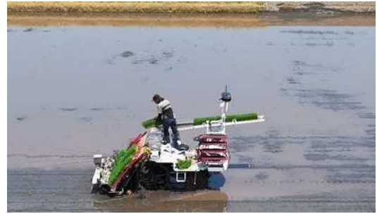
自動操舵機械での移植状況(舟形町)
